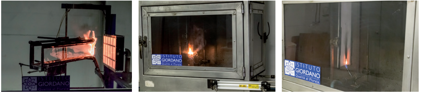
Test di piccola fiamma UNI 8456
