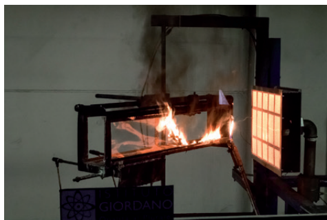
Testa al pannello radiante UNI 9174
