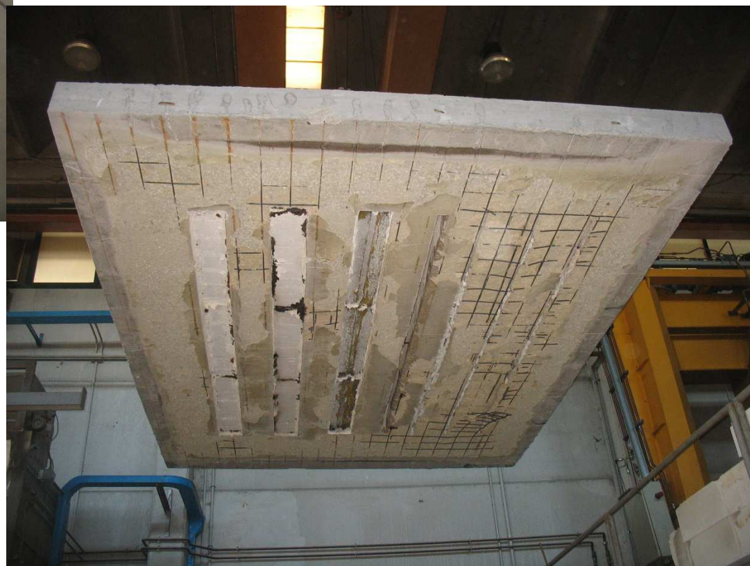
Campione dopo la prova faccia esposta al fuoco
