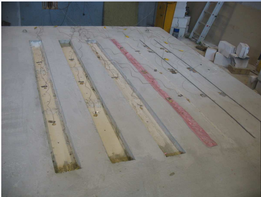
Campione prima della prova faccia non esposta al fuoco
