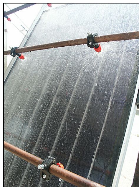
Nella foto: prova di shock termico esterno
