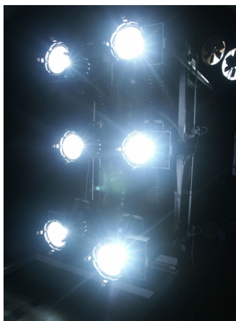
Nelle foto: prova di rendimento termico indoor con simulatore solare
